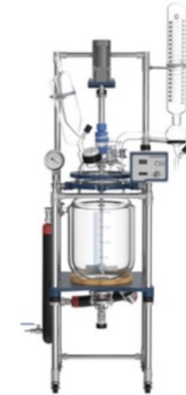
Figura 4.6: Esempio di reattore da laboratorio costruito in vetro borosilicato.
