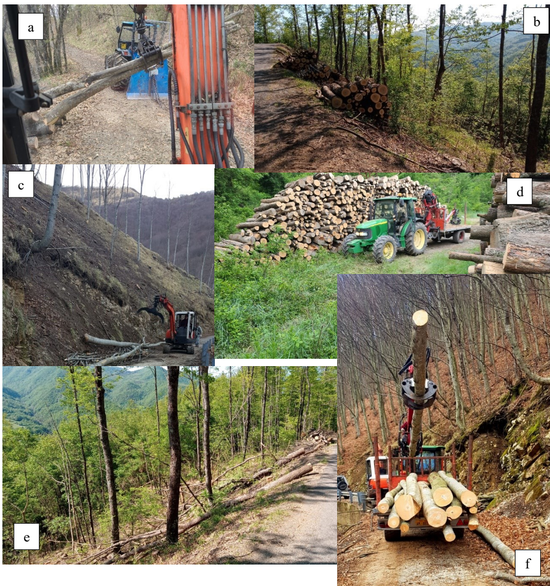
Figura 22 - a) trattore e verricello, b) legname concentrato e allestito in attesa dell'esbosco, c) l'area utilizzata nel 2019 della faggeta durante le operazioni, d) imposto dell'area a ostrieto, e) alberi interi concentrati in attesa di allestimento, f) carico del rimorchio durante l'utilizzazione della faggeta. Foto a, c, d, f di Emiliano Zanardi e Samuele Pisotti
