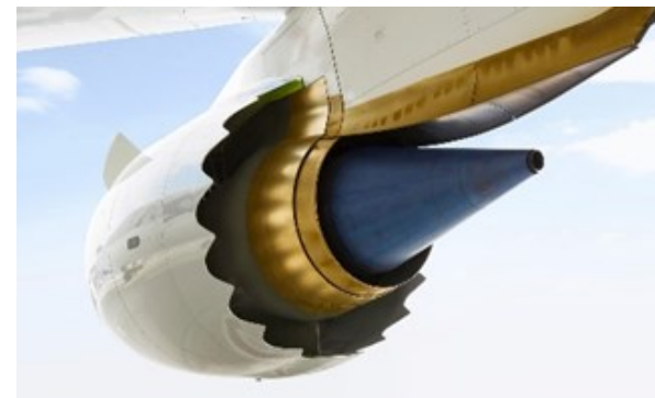
Fig.: Ugello freddo a lobi Chevron GENx [geaerospace.com]
