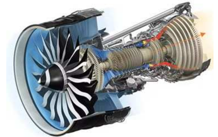
Figura: Vista in sezione motore turbofan GE90 [Wikipedia]
