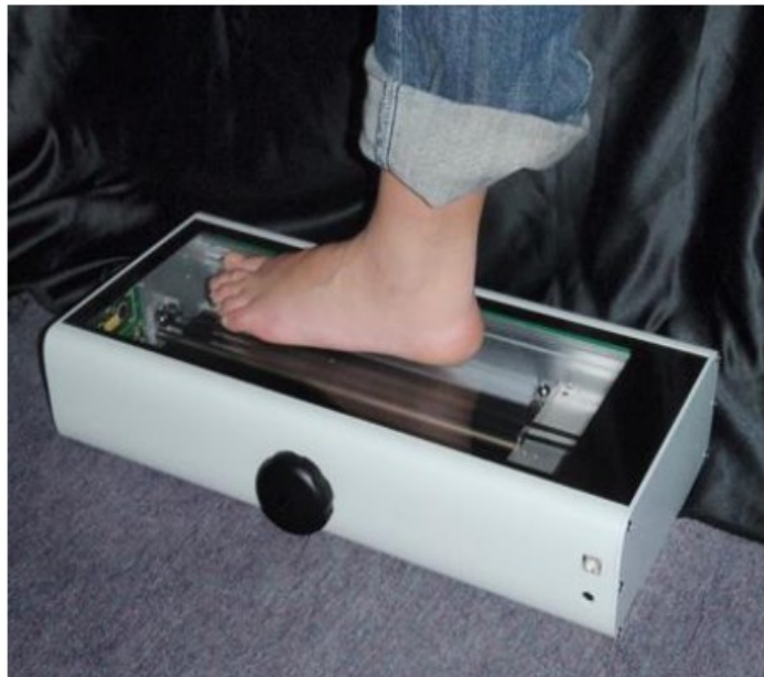
Figura 2.7: Scanner 3D plantare mentre esegue una scansione su paziente
