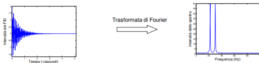
Figura 17 Trasformata di Fourier di un FID per ottenere uno spettro NMR
