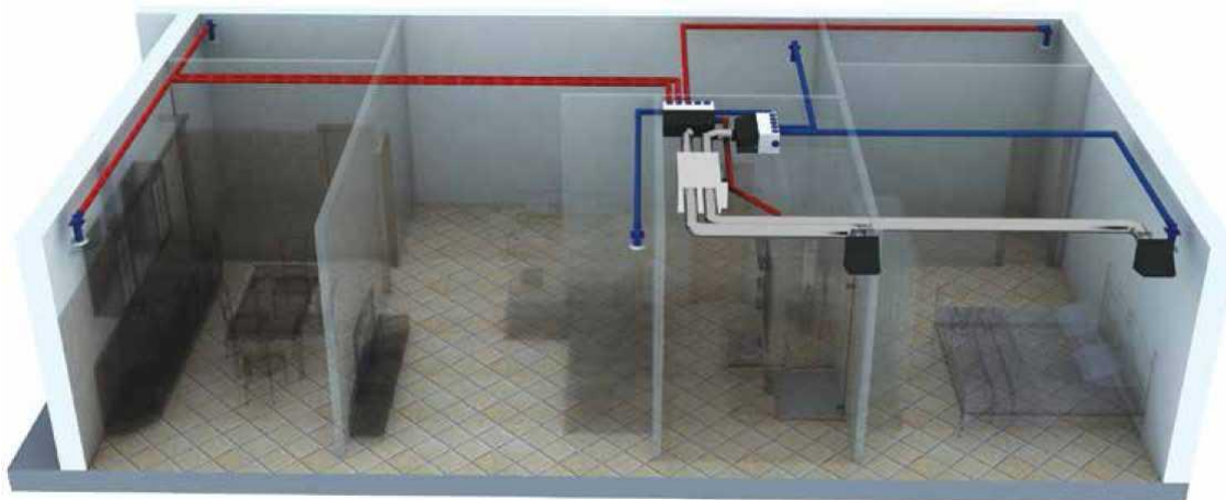
Figura 12: Esempio di normale impiego di un recuperatore sensibile nella VMC residenziale per garantire il ricambio dell'aria.
