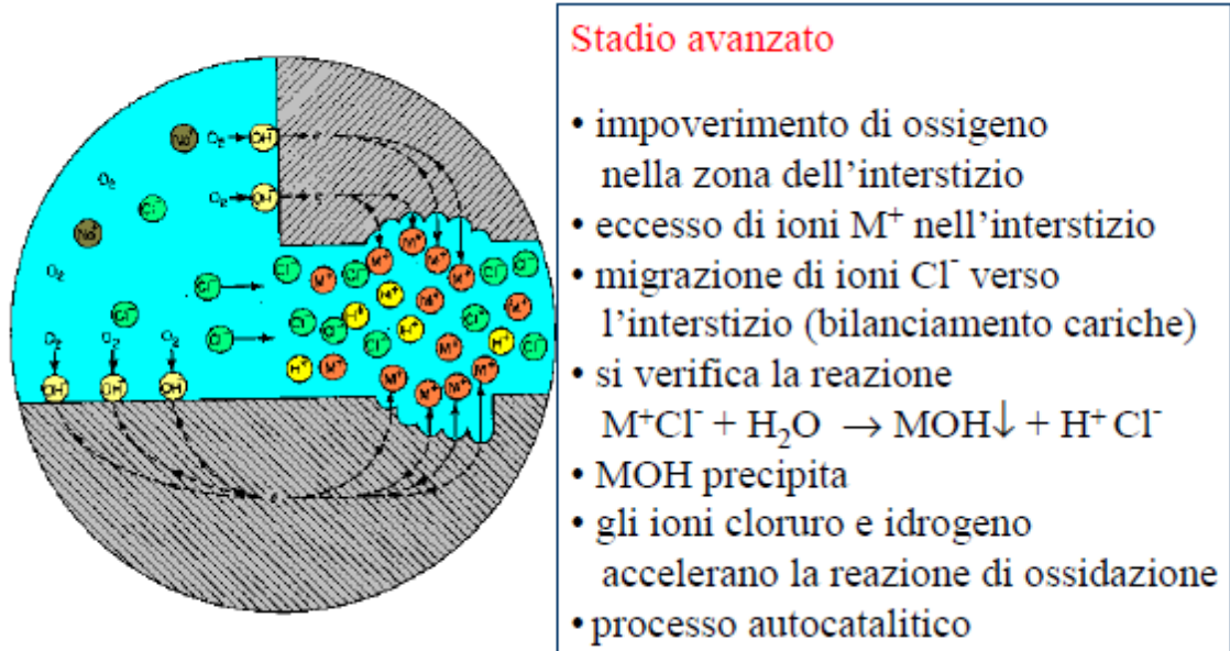
Figura 1.10 – Esempio di corrosione dovuta al crevice (stato avanzato) [3]
