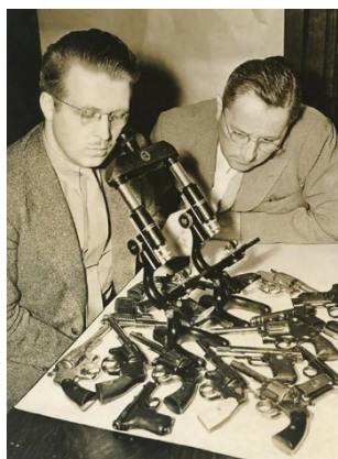
Figura 1.1: Microscopio comparatore per determinare da quale arma specifica provenivano i proiettili recuperati sulla scena del crimine. Nella foto sono ritratti Joseph Wilimovsky e il dottor Calvin Goddard
