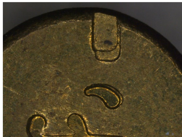
Figura 4.21: Improntamento del bossolo sparando in verticale verso l'alto con una Beretta 21A
