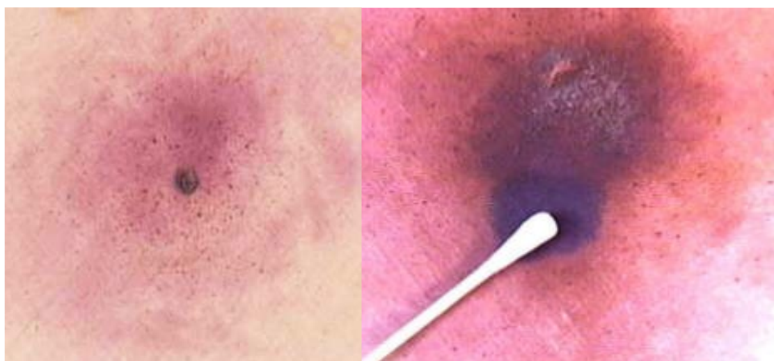
Figura 2.21: Reperto prima e dopo l'aggiunta della soluzione di HCl. Se è presente piombo la zona si colorerà di blu/viola
