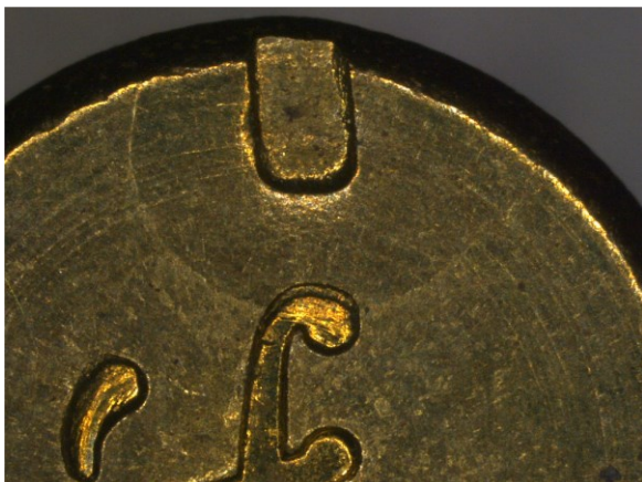
Figura 4.20: Improntamento del bossolo sparando in orizzontale con una Beretta 21A
