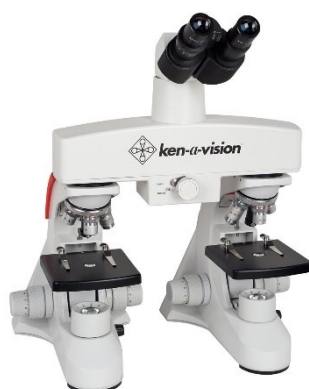
Figura 1.3: Microscopio comparatore moderno
