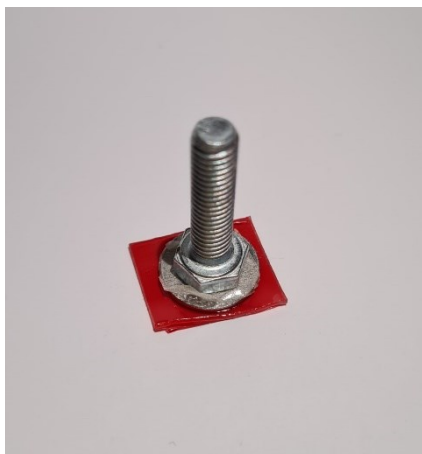
Figura 3.4: Stub artigianale costruito per la raccolta dei residui dello sparo sulle mani del tiratore
