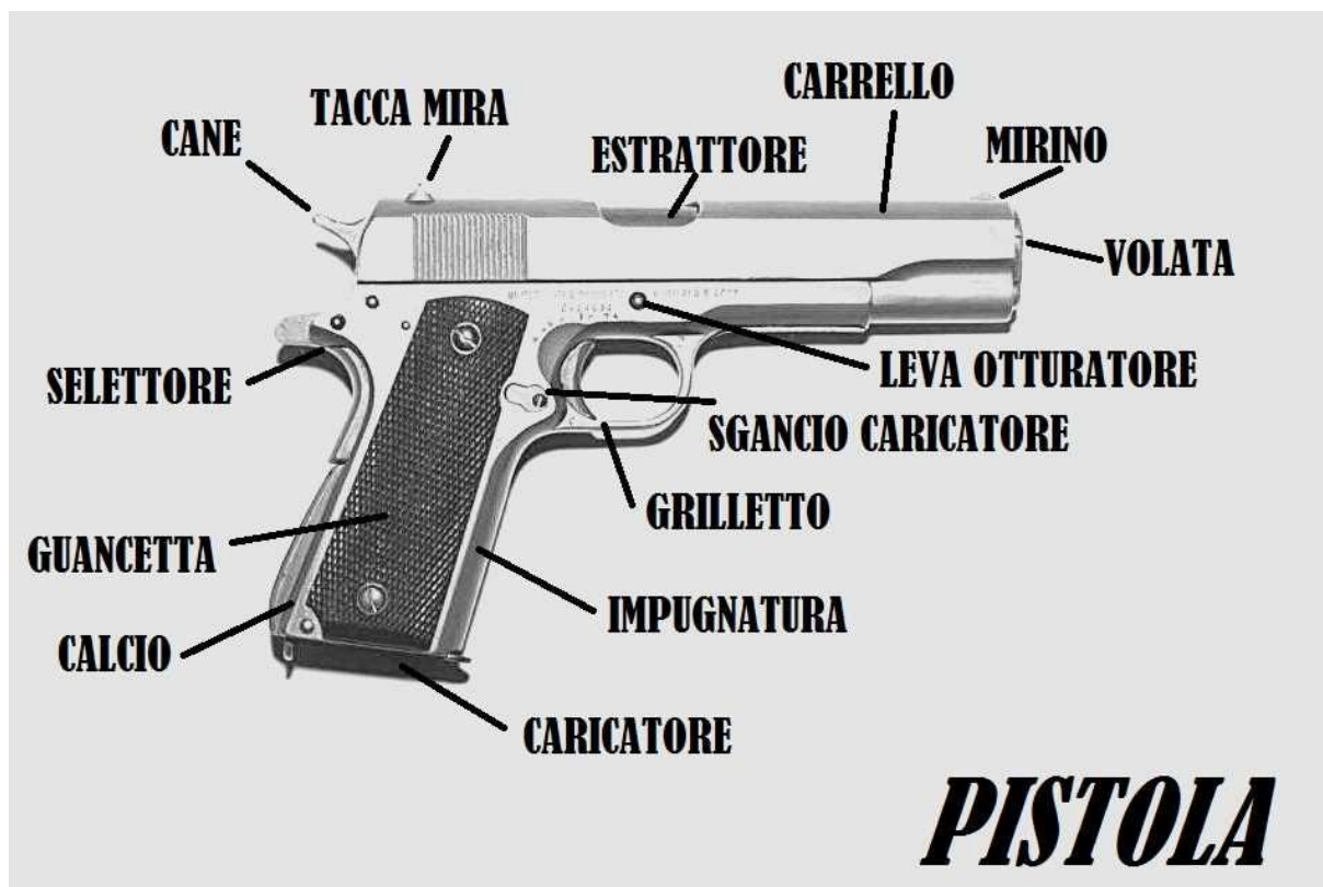
Figura 1: Componenti principali di un'arma corta. Immagine tratta da [2]
