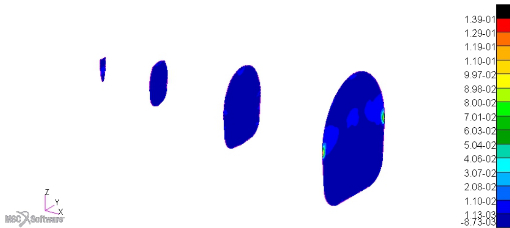
Figura 4.20: Involuppo A: failure indices sulle ordinate in caso di cupolino completamente attaccato alla scocca.
