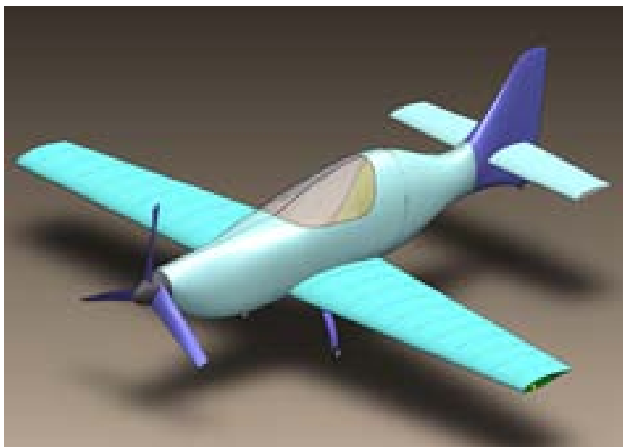
Figura 1.6: Modello CAD preliminare del Merlo, l'ultraleggero in progettazione dai ragazzi del "Learn to Fly".
