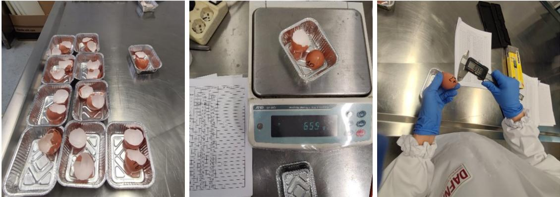
**Figura 5.5.** Gusci dopo essiccamento in stufa per 24 h (a sinistra); pesata del guscio (al centro); misurazione dello spessore del guscio con calibro digitale (a destra)
