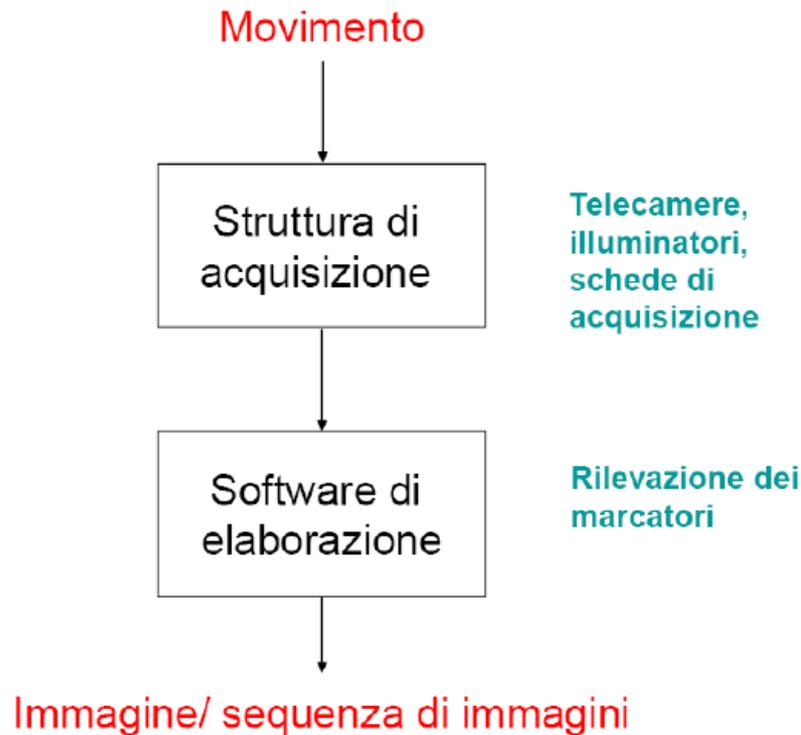
**Architettura di un sistema di acquisizione**
