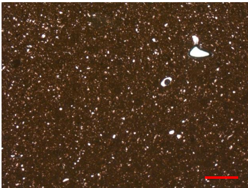
Figura 7: Immagine in microscopia ottica in luce polarizzata del campione 11727.6 appartenente al gruppo petrografico delle ceramiche depurate (lunghezza barra: 500 \mu\text{m} ).
