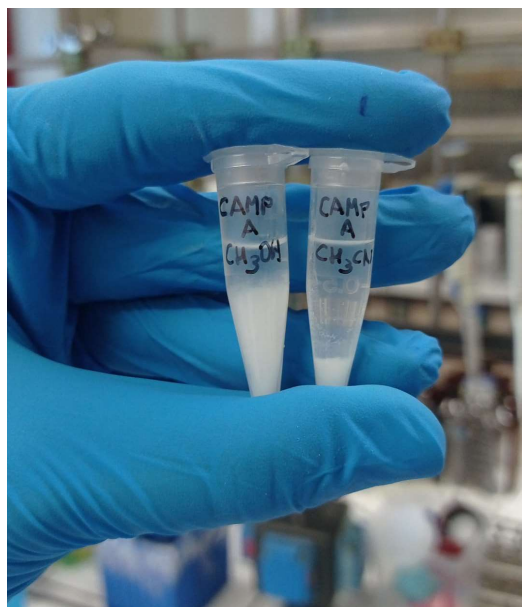
Figura 30: confronto tra estrazione effettuata con solvente acetonitrile e con solvente metanolo.
