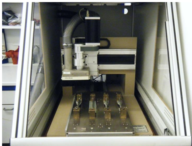
Figura 3.4. Fresa utilizzata per creare i provini ad osso di cane
