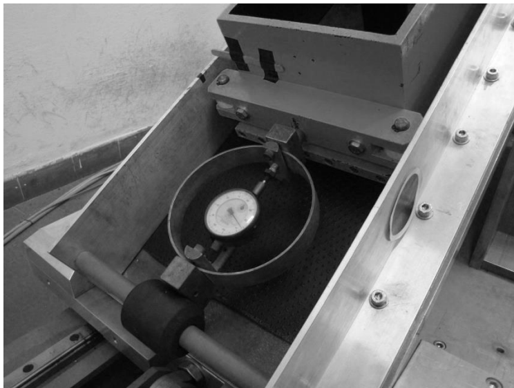
Figura 5.5 Dettaglio relativo alla prova con il metodo della forza
