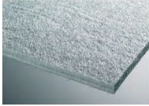
Figura 1.1 Rotolo di geotessuto tessuto (sinistra); dettaglio del geotessuto non tessuto (destra)
