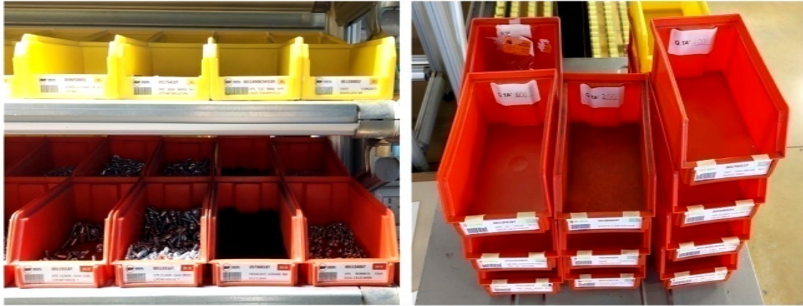
Figura 3.12: Doppio contenitore per ogni referenza (sinistra) e contenitore vuoto a bordo linea (destra).
