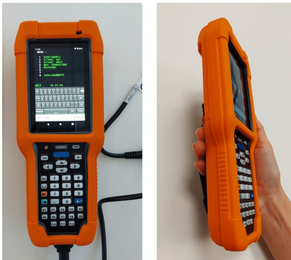
Figura 7.12: Palmare che verrà utilizzato per scannerizzare i codici e per registrare le operazioni.
