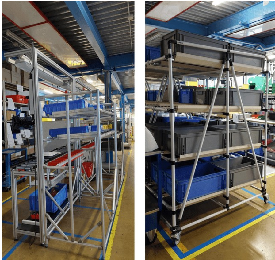
Figura 6.5: Esempi di due zaini per le attuali linee di produzione OPDEplus XS e OPDEplus.
