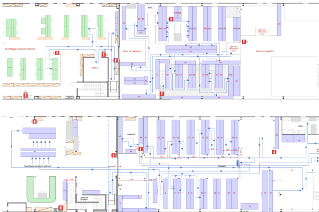
Figura 3.5: Spaghetti Chart dei prodotti OPDE Plus XS in BDF Digital (Marcon S., Tesi di Laurea, Università degli Studi di Padova, 2022).
