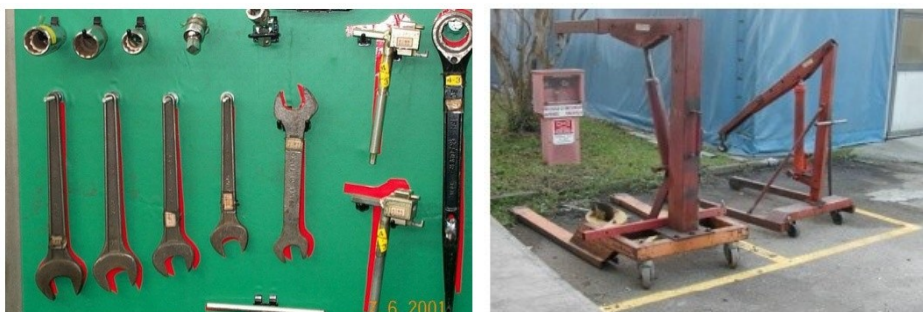
Figura 3.14: Sagome e marcature per riporre gli strumenti e le attrezzature (Panizzolo, Università degli Studi di Padova, 2022-2023).
