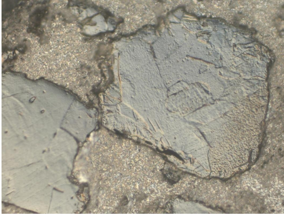
Immagine 3.4: campione A al microscopio ottico dopo attacco Kroll (500x).
