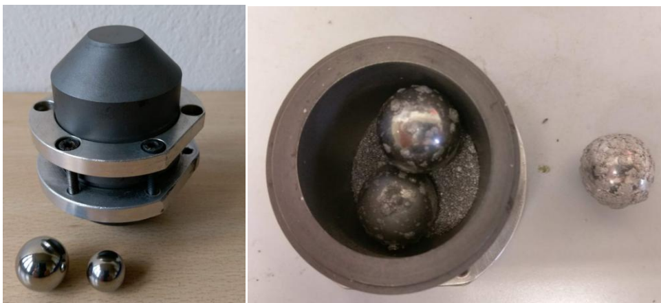
Immagine 2.2 e 2.3: contenitore di macinazione prima e dopo alligazione meccanica di 3h: da notare come l'alluminio si salda sulle sfere di acciaio.
