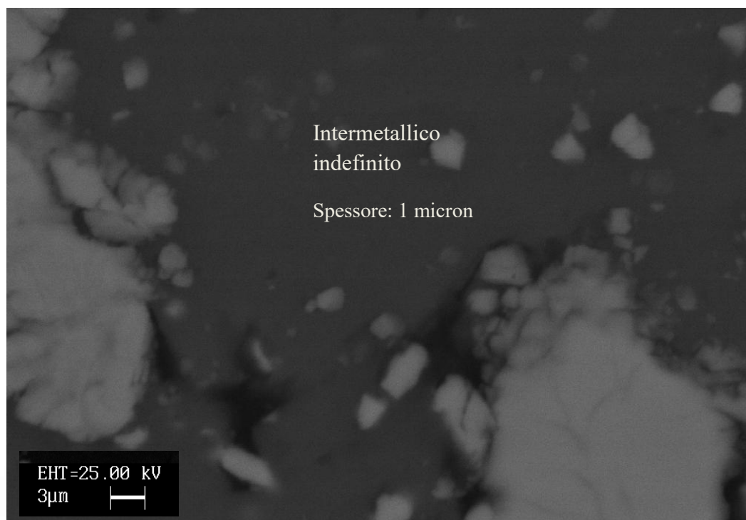
Immagine 3.37: intermetallico campione D1. Analisi quantitativa : 87,12 % Al 12,88 % Ti.
