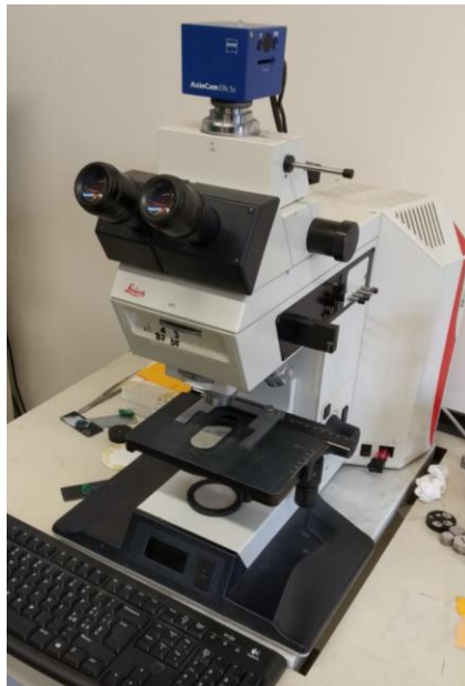
Immagine 2.4: microscopio ottico Leica DMR, camera Leica DC100.
