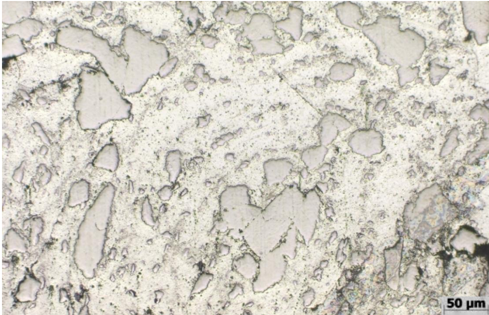
Immagine 3.23: campione A1 al microscopio ottico (200x).
