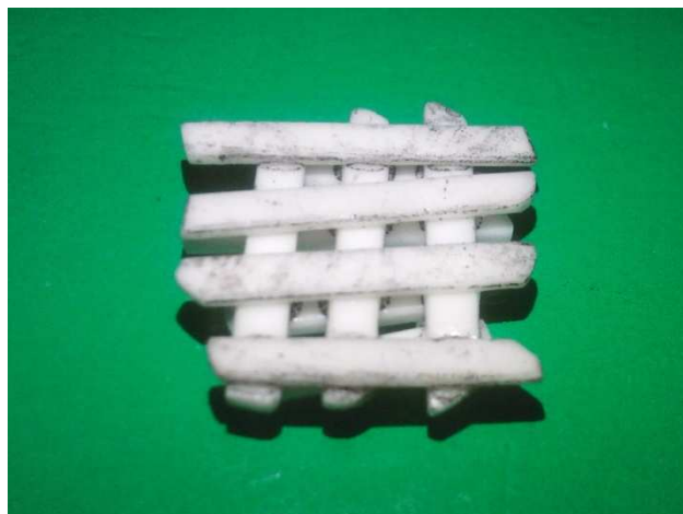
Figura 5.6: Immagine relativa al materiale cellulare realizzato con vetroceramica N6 con un trattamento di sinterizzazione di 3h a 950°C, in cui è stato utilizzato del silicone per mantenere la regolarità nella struttura.
