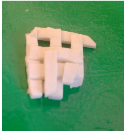
Figura 5.7: immagine del provino ottenuto una volta che è stato realizzato il trattamento di tempra chimica in bagno di sali fusi.
