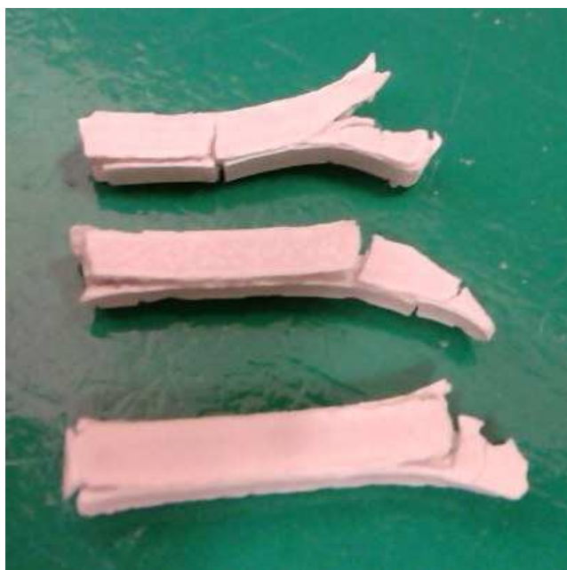
Figura 4.25: Foto relativa ai campioni in vetroceramica N6 temprati per otto ore in bagno di sali di KCl e \text{K}_2\text{SO}_4 .
