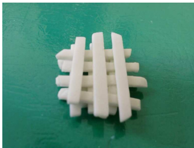
Figura 5.5: Immagine relativa al materiale cellulare realizzato con vetroceramica N6 con un trattamento di sinterizzazione di 3h a 950°C.
