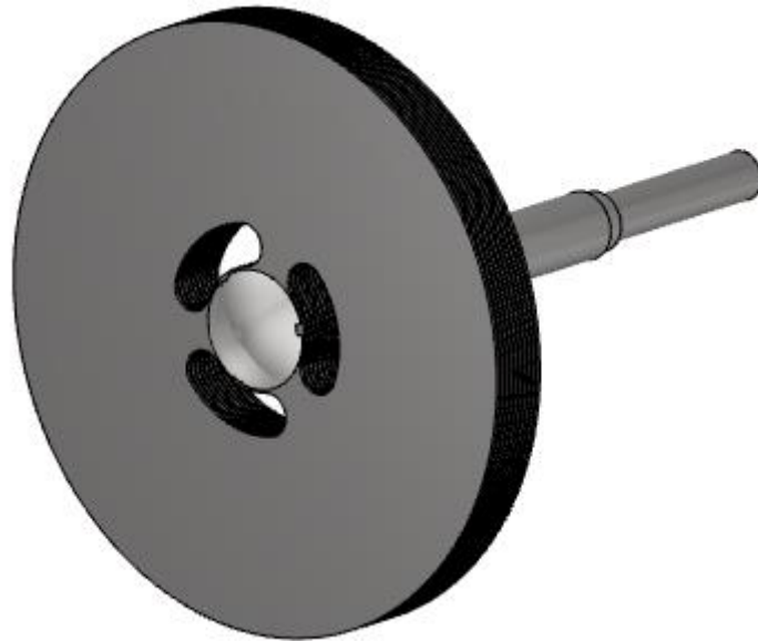
Figura 10. Vista in 3D del pacco di dischi calettati sull'albero
