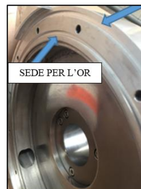
Figura [3] Particolare del traferro
