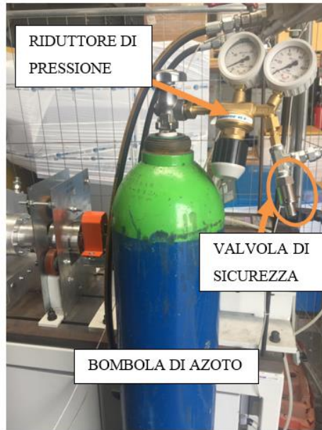
Figura 12. Prove di tenuta con azoto in pressione
