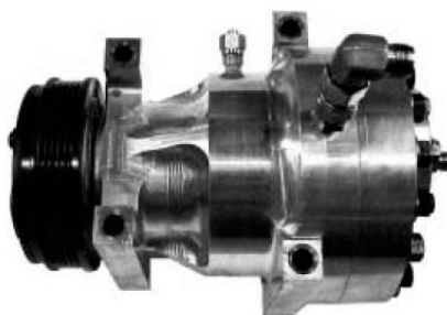
Figura 4.7 – Compressore scroll per uso automobilistico della Mitsubishi Heavy Industries
