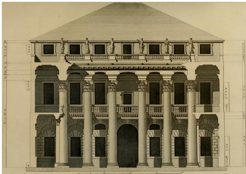
Figura 32. Sezione di Palazzo Iseppo da Porto con loggiato sul cortile realizzata da Bertotti Scamozzi. Fonte: Bertotti Scamozzi 1968, vol. I, tav. VIII.
