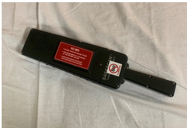
Figura 2.24: Rilevatore di componenti ferromagnetiche (Safescan Target Scanner) del sito RM dell'Ospedale Santa Maria della Misericordia di Rovigo (retro)
