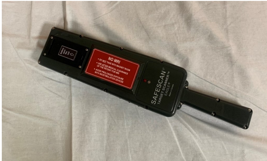
Figura 2.23: Rilevatore di componenti ferromagnetiche (Safescan Target Scanner) del sito RM dell'Ospedale Santa Maria della Misericordia di Rovigo (fronte)
