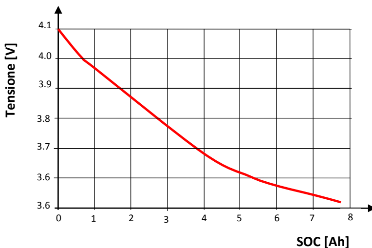
Figura 58: Curva di correlazione OCV-SOC per una batteria al litio, dai risultati di figura precedente
