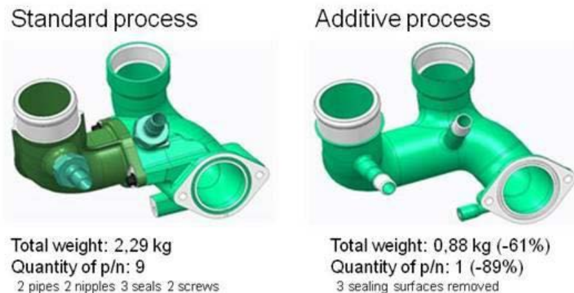
Figura 1.2: confronto fra due pezzi equivalenti ottenuti tramite lavorazioni tradizionali ed attive manufacturing. Immagine tratta dall'articolo [15].
