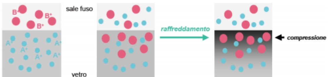
Fig.2.22 – Processo di scambio ionico
