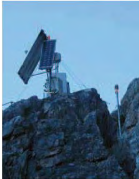
Fig. 3.6: La stazione di monte. Si notano la stazione meteorologica Vaisala, l'antenna per la trasmissione dati ed il pannello solare. Da [Scotton et al. (2011)]
