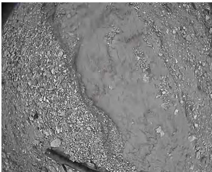
Fig. 5.10: Ripresa dell'alveo alle ore 10.00 in corrispondenza della stazione di valle. Le sponde vengono erose dall'arrivo dell'aumento della corrente liquida. Il laser non rileva scostamenti.
