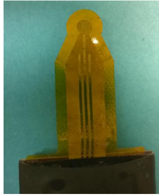
Figura 33: sensore kapton con raggio si 2mm
