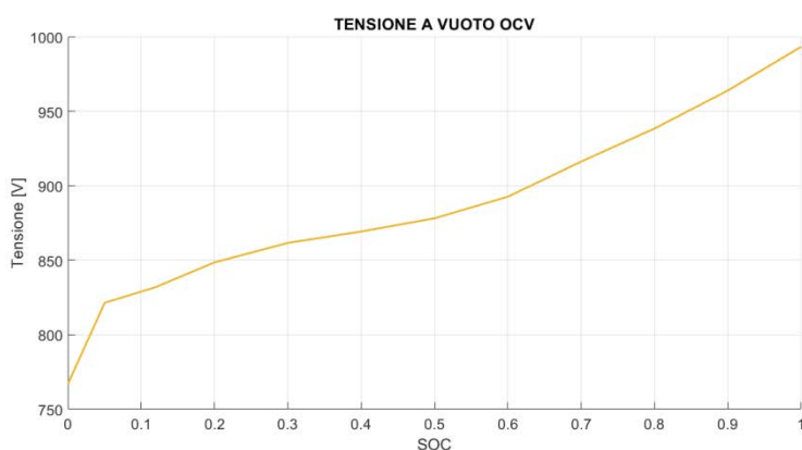
Figura 45 Tensione a vuoto (OCV) della batteria
