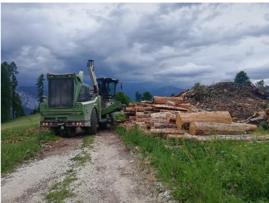
Figura 2.1.3.3: cippatrice di Duferco Biomasse Srl presso l'imposto della gru a cavo di Valle mentre si accinge a cippare biomassa da tronco (cippato bianco) e ramaglia (cippato verde). Luglio 2021
