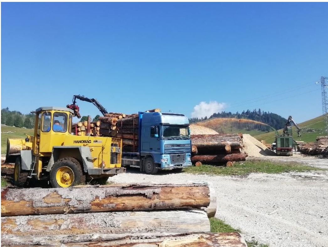
Figura 2.1.3.2: autotreno con gru dei F.lli Barbieri Snc mentre scarica la biomassa; sullo sfondo la cippatrice al lavoro crea cumulo
