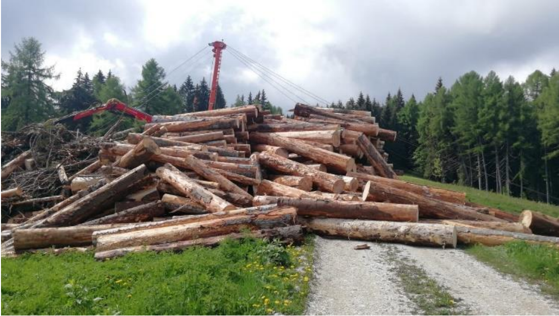
Figura 2.1.1.9: gru a cavo del lotto Valle: risultato dovuto a due giorni di lavoro con imposto ridotto e mancanza di trasporto di legname
