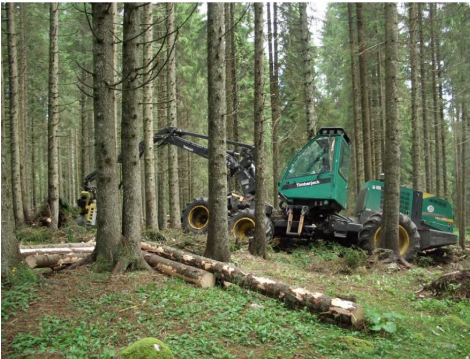
Figura 1.1.3.1: Harvester impiegato nella raccolta di piante deperienti nel Bosco delle Doghe (luglio 2009)
