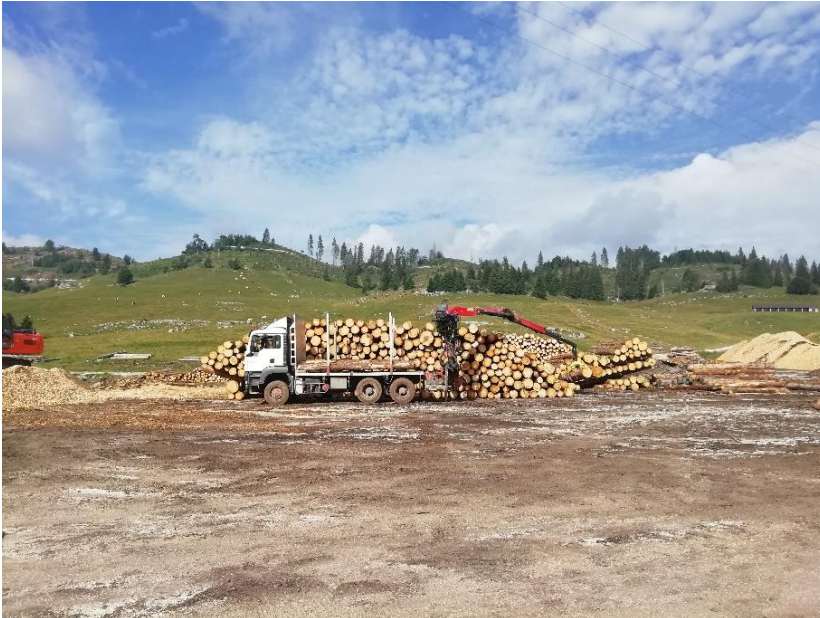
Figura 2.1.1.11 : autocarro con gru mentre realizza una catasta con il legname proveniente dalla gru a cavo del lotto Conca di Enego
