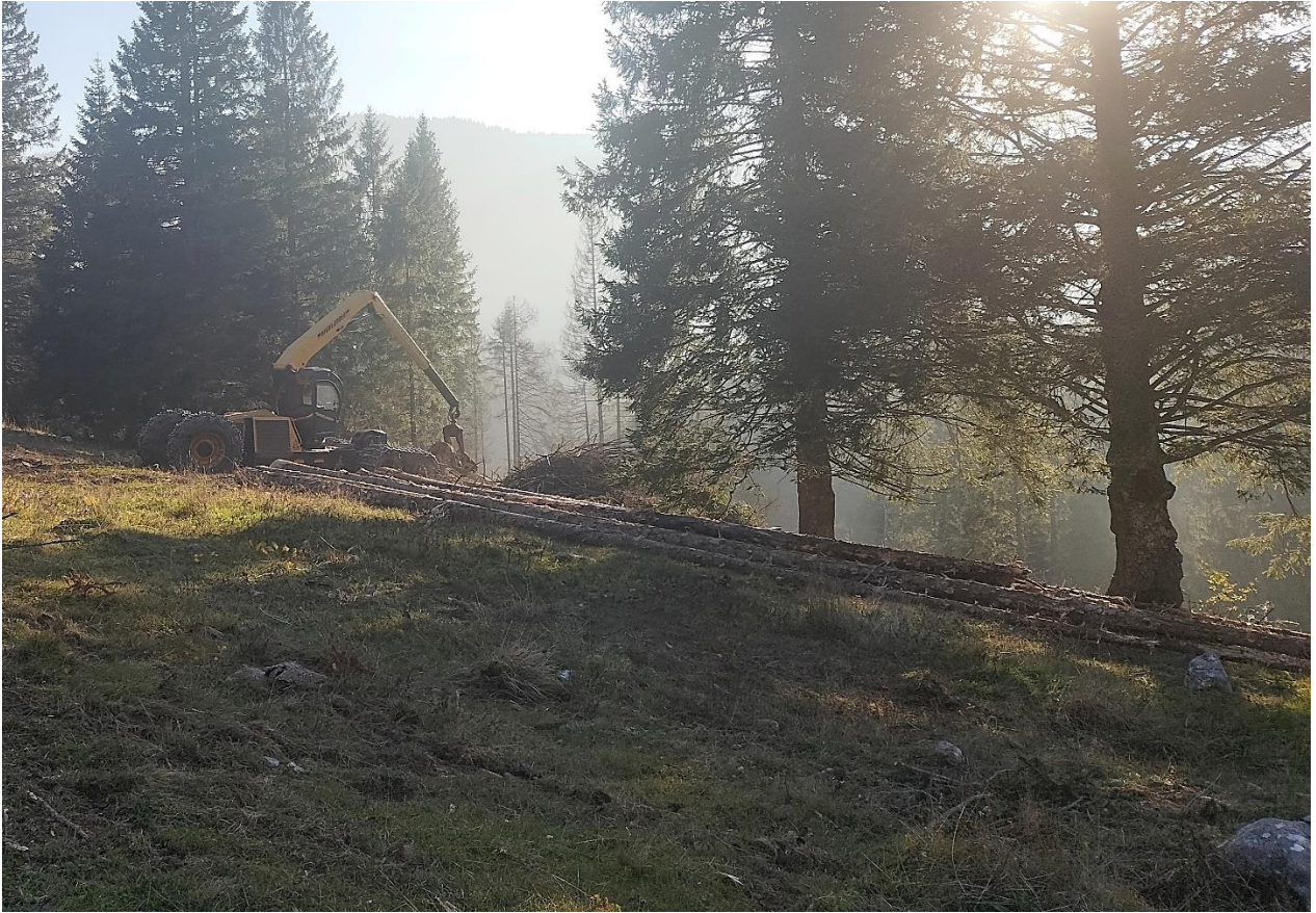
Figura 2.1.1.3: Highlander sul lotto Strada Brustolade. In questo caso la macchina utilizzava il verricello per avvicinare i fusti interi alla zona pianeggiante al limite della particella e processarli dove potevano essere raggiungibili dal forwarder.
