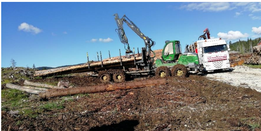
Figura 2.1.3.1 : imposto del lotto Laghetti di Grigno, il quale coincide con il piazzale di carico, essendo l'esbosco corto. Luglio 2020.
