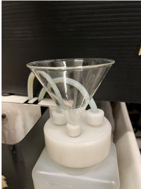
Figura 30. Tappo ingegnerizzato e creato dall'officina meccanica dei LNL.
