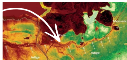
Modello digitale del terreno derivato da scansione LIDAR con evidenziato l'antico percorso dell'Adige
