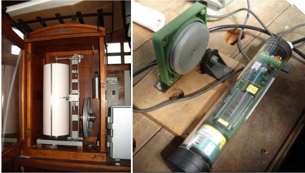
Figura 4.2: A sinistra: mareografo meccanico con mareogramma cartaceo. A destra: mareografo digitale in servizio presso la stazione di Punta della Salute. Fonte: ISPRA.
