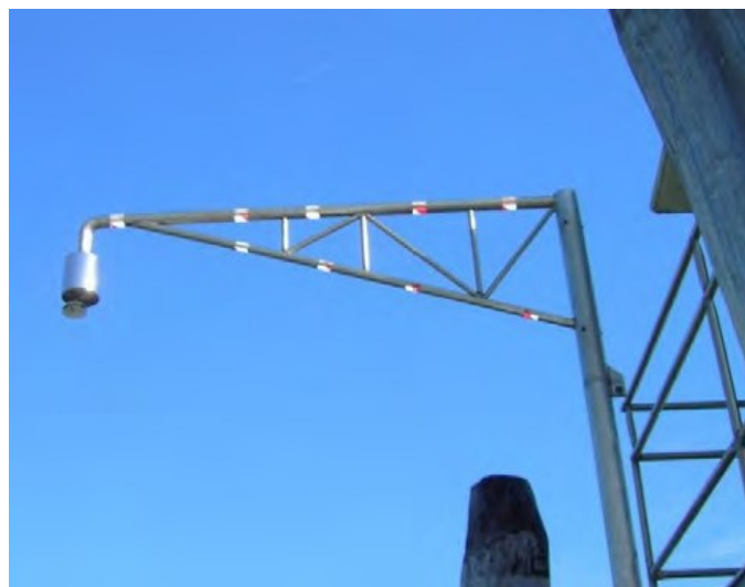
Figura 4.3: Ondametro ad ultrasuoni presente nella stazione di Murano. Fonte ISPRA.
