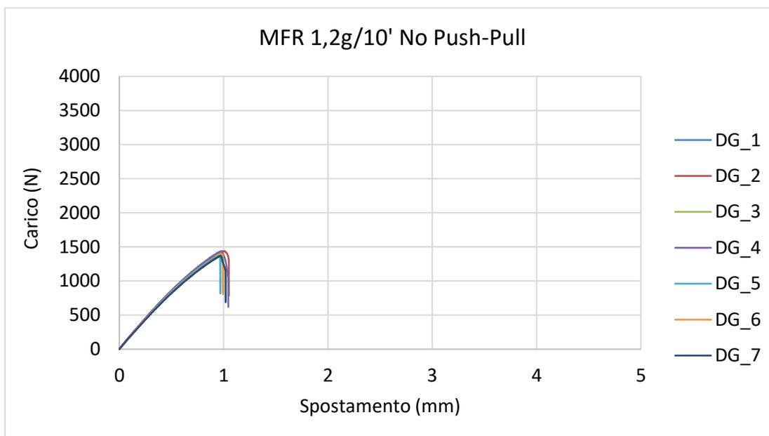
**Figura 3. 2:** Curve carico-spostamento per provini double gate con  $MFR=1.2g/10'$ .
