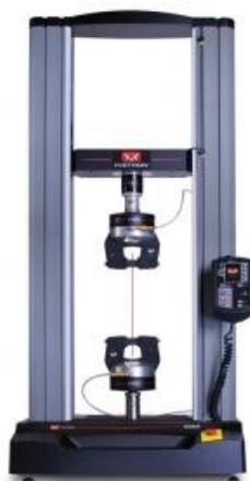
**Figura 2. 38:** Macchina per le prove di trazione: Instron 5966.
