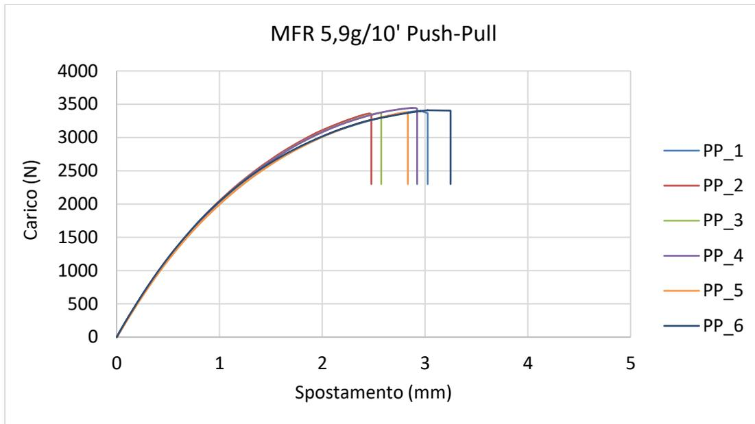
**Figura 3. 7:** Curve carico-spostamento per provini realizzati applicando il processo di push-pull con  $MFR=5.9g/10'$ .
