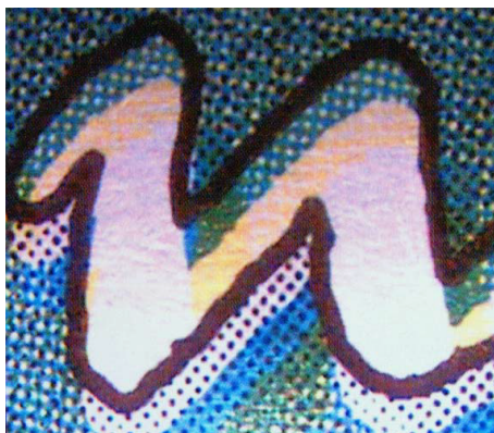
Figura 5.3: Esempio di stampa con errore di registro.
