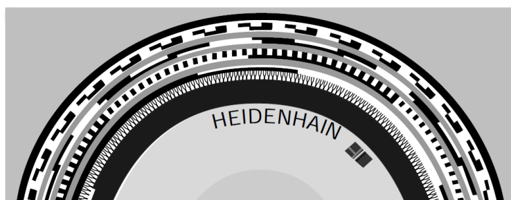
Figura 4.10: Disco ottico di un encoder assoluto con codifica Gray.
