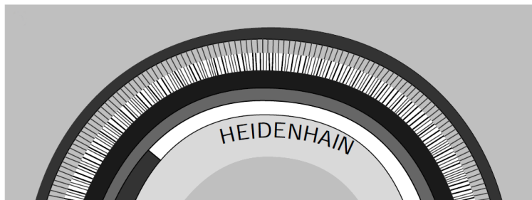
Figura 4.11: Disco ottico di un encoder assoluto con traccia a codice seriale.
