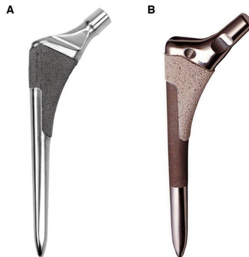
Figura 4.11 A) stelo femorale Trabecular Metal Zimmer-Biomet con rivestimento prossimale di Ta poroso e B) stelo femorale VerSys HA/TCP Fiber Metal Zimmer-Biomet con rete in fibra di Ti e rivestimento prossimale di fosfato di calcio.
