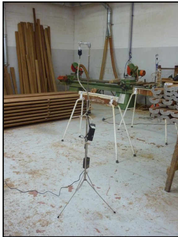
Figura 3.1: esempio di campionamento in posizione fissa.
