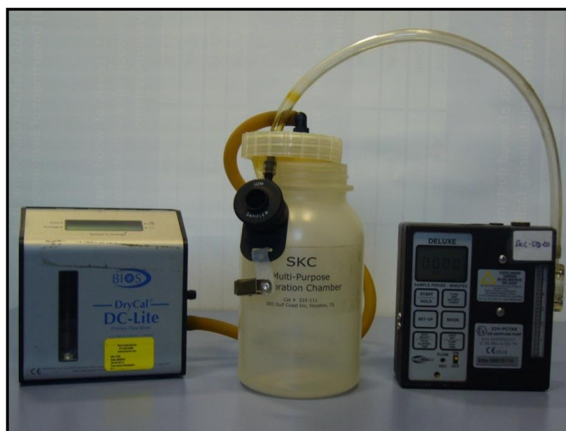
Figura 3.6: sistema di taratura del flusso aspirante delle pompe.
