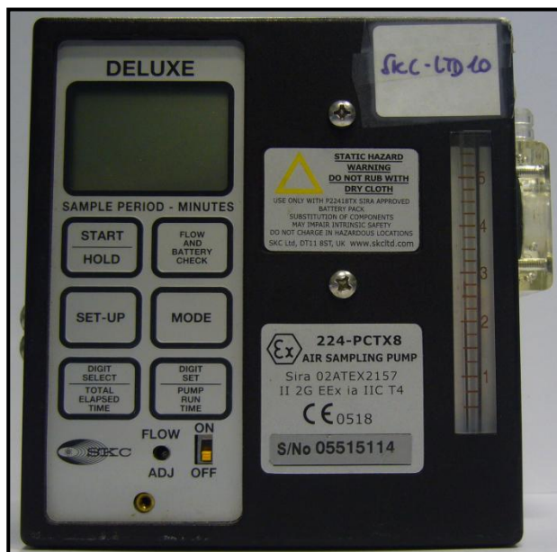
Figura 3.5: esempio di pompa aspirante SKC.
