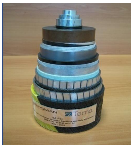
Figura 1.2 - cavo con isolamento carta impregnata
