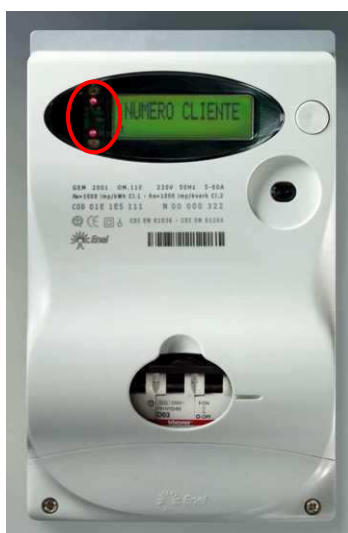
Fig.6.5 – Contatore elettronico ENEL.
