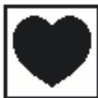
fornisce un piú elevato grado di protezione contro i pericoli elettrici rispetto a quello fornito dalle parti applicate di tipo BF.
