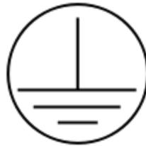
contro i contatti diretti ed indiretti non consiste soltanto nell'isolamento fondamentale, ma anche in una misura supplementare di sicurezza consistente nel collegamento dell'apparecchio al conduttore di protezione del cablaggio fisso dell'impianto in modo tale che le parti conduttrici accessibili non possano andare sotto tensione per un guasto dell'isolamento fondamentale.
