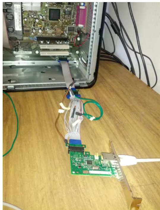
Figura 24: Collegamento della scheda al computer per mezzo della prolunga modificata
