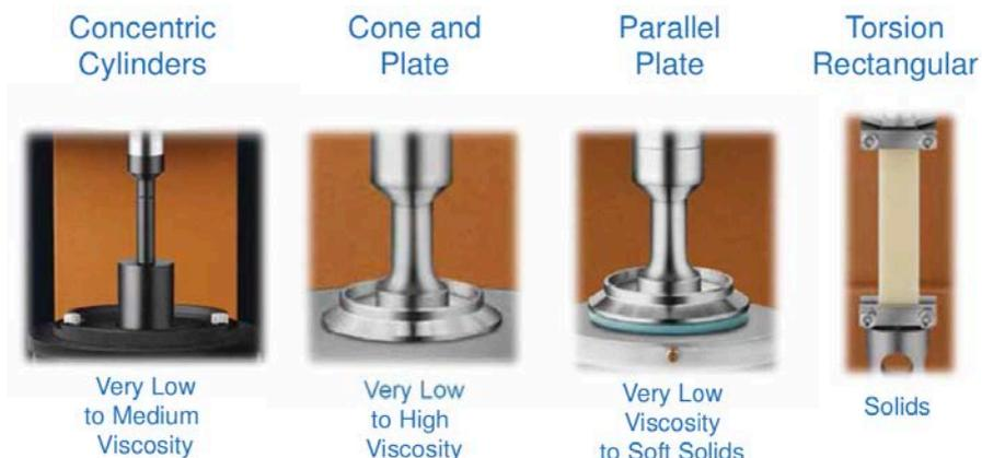
Figura 25: Rappresentazione delle diverse geometrie utilizzabili
