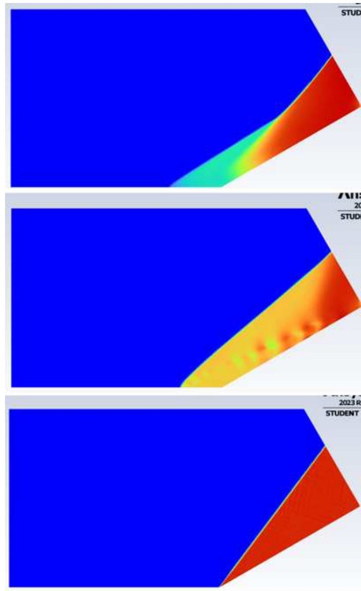
Figura 3.29: Campo di pressione statica per rampa inclinata di 30^\circ ottenuto con modello RANS viscoso, modello RANS inviscido e modello fedele alle Teoria delle onde d'urto oblique
