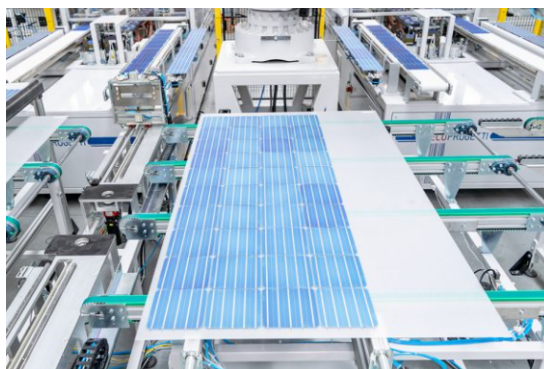
Figura 1.1: Stringhe di celle fotovoltaiche durante la fase di layup.
