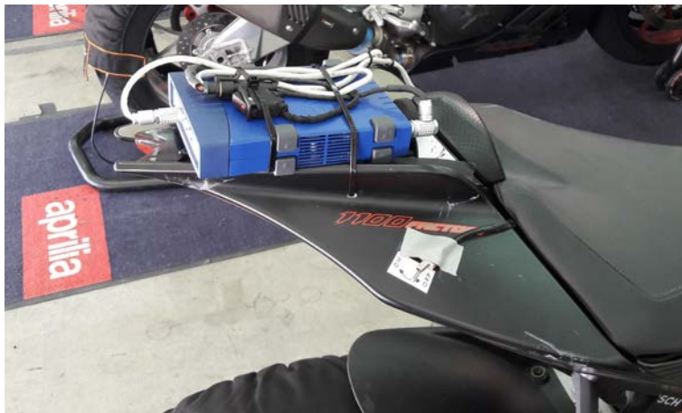
Figura 4.2: Centralina Etas ES910.3 installata sul codone della motocicletta; questo modulo permette l'esecuzione online dell'algoritmo.
