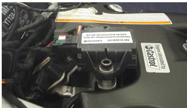
Figura 4.4: Posizione di montaggio delle piattaforma Bosch MM7.10 inclinata di 42^\circ , necessaria per il funzionamento del veicolo e della piattaforma prototipo Continental SC13S, a sei assi, installata orizzontalmente.
