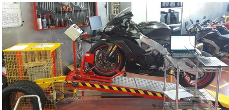
Figura 4.5: Banco inclinato utilizzato nel test statico; dal pannello di controllo si impostano i gradi di impennata desiderati, che vengono raggiunti tramite l'azione di un pistone posizionato sul davanti della piattaforma.
