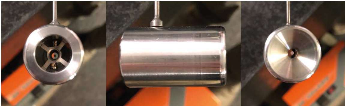
Figura B.1: particolare del supporto del catodo e dimensioni della targhetta del filamento. In ordine da sinistra a destra: la superficie rivolta verso la sorgente del laser, la superficie laterale del supporto e la superficie di forma conica rivolta verso l'anodo per la focalizzazione del fascio
