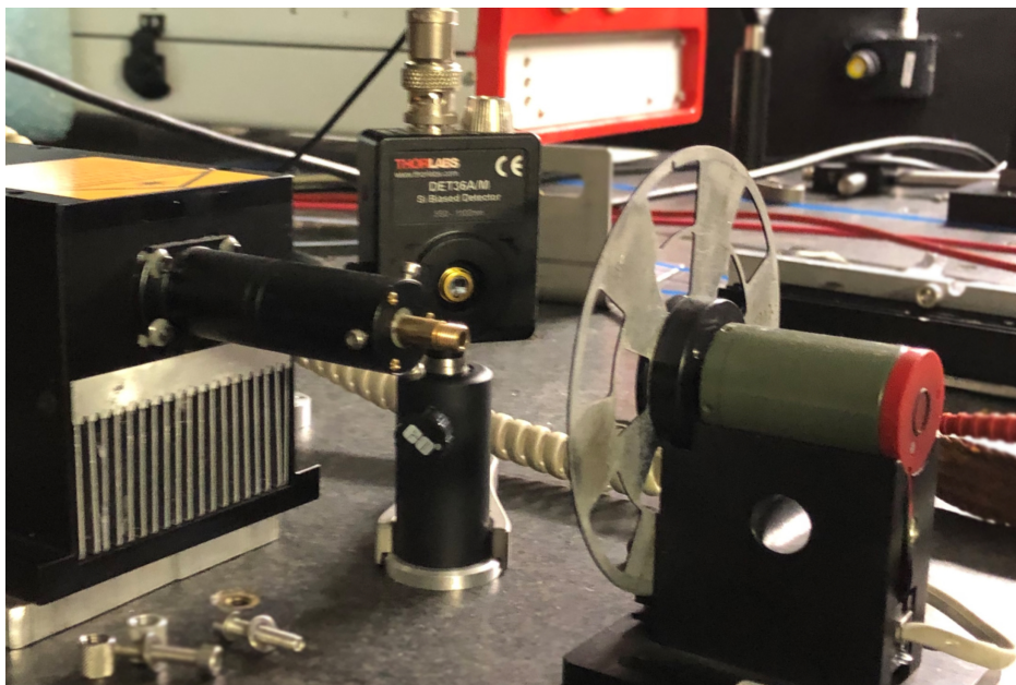
Figura B.2: dettaglio della ruota ottica usata per la misura del tempo di accensione e spegnimento della corrente. A lato della sorgente laser si può osservare il fotorivelatore usato nella misura del segnale riflesso.
