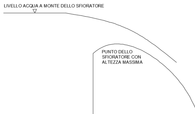
Figura 32. Schema altezza massima dello sfioratore.
