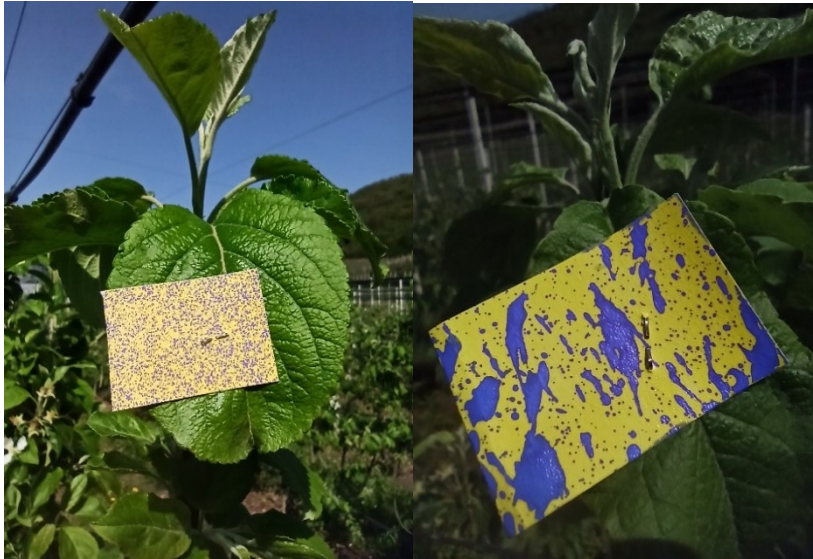
Fig.2.7 Esempio di copertura ottenuta dall'atomizzatore (a sinistra) e dallo StripNetX™ (a destra)
