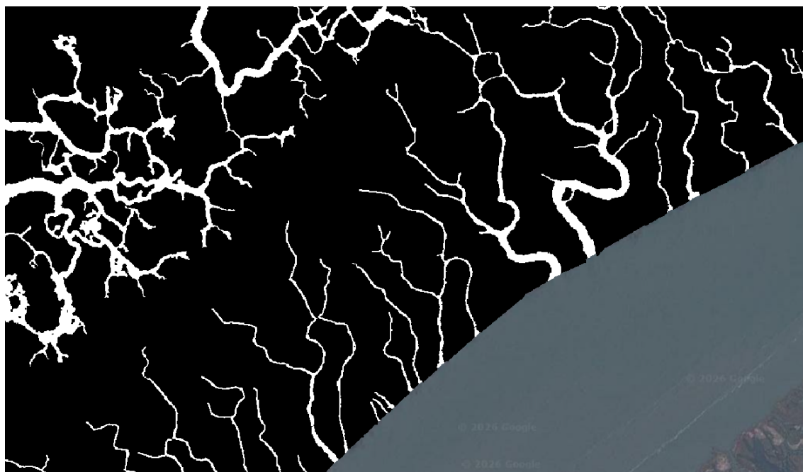
Figura 3.5 Riquadro di dettaglio della mappa binaria della rete di canali ottenuta per il caso studio di Sapelo Island
