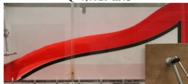
Prova N°13 Q=0,0350 \text{ m}^3/\text{s}
