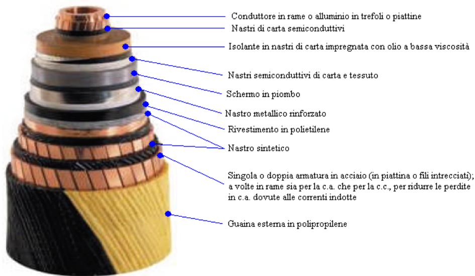
Figura 1.5 Cavo riempito in olio SCFF
